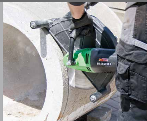
langs de rand werken met accessoireset + diamantzaagblad (accessoire)
