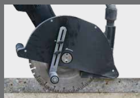
nauwkeurige zaagdiepte-instelling (accessoire)
