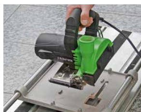
bevestigen van de zaag zonder enig gereedschap
