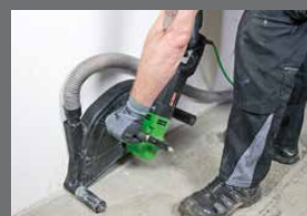
langs de rand werken met accessoireset + diamantzaagblad (accessoire)
